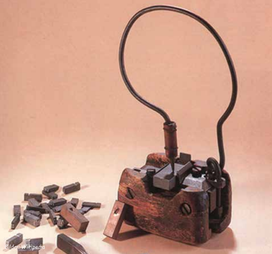
Handgiessinstrument mit gegossenen Lettern.
